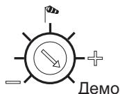
Для тестирования и демонстрации функций устройства управления возможно сокращение времени реагирования устройства Soliris RTS до нескольких секунд.
