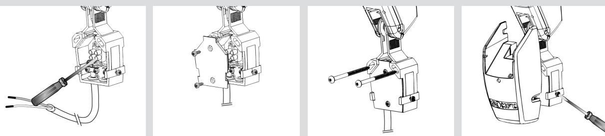
Провода подключаются в соответствии с расположением клемм.
